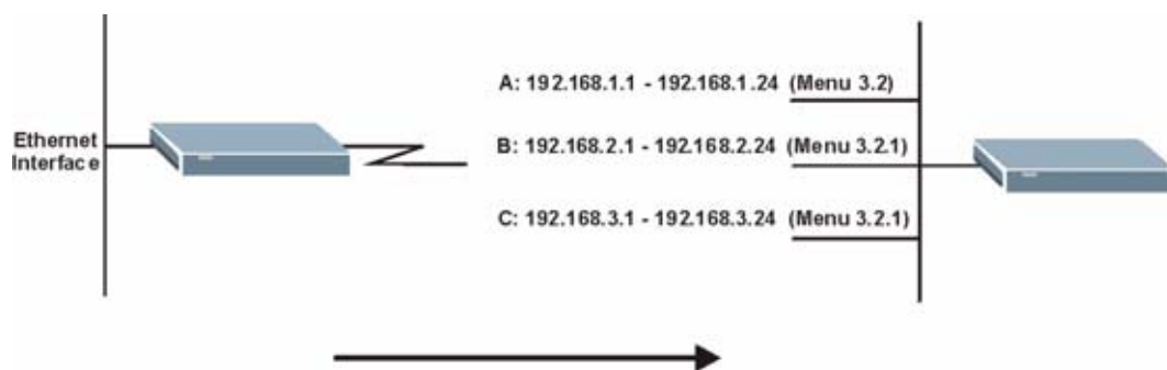
Рис. 68 Пример сети с использованием псевдонимов IP
